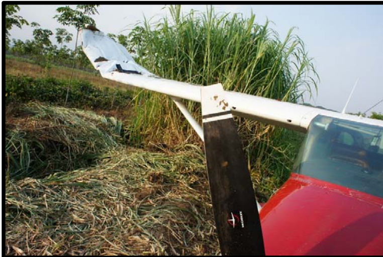
Fotografía No. 4 Ala derecha con daños.
