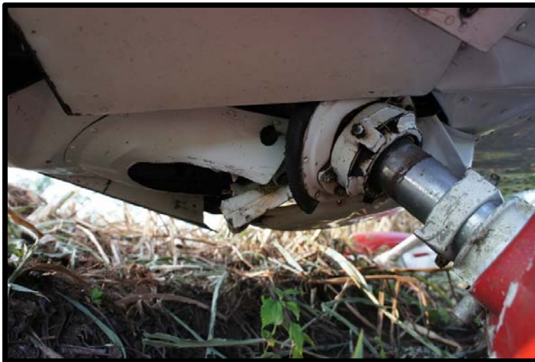
Fotografía No. 10 Rotura del soporte del Tren de Nariz.
