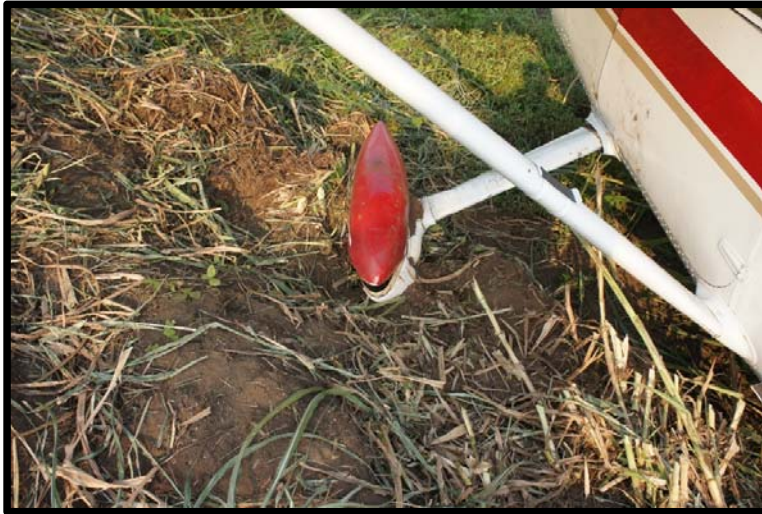
Fotografía No. 5 Tren derecho con daños.
