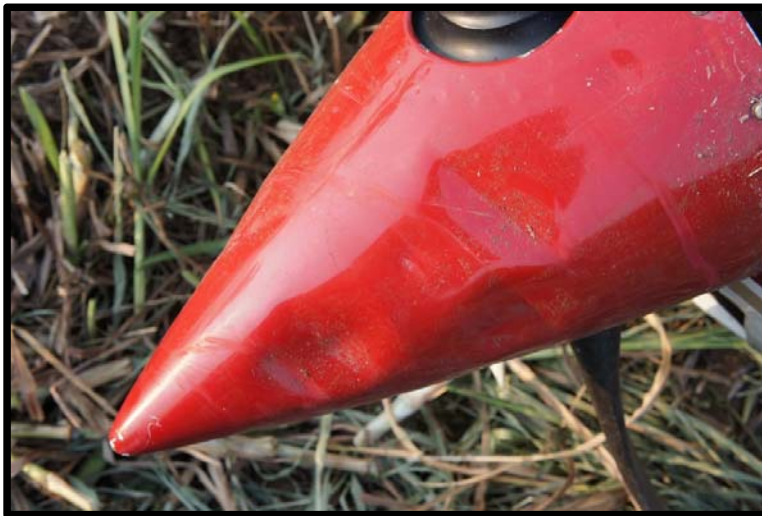
Fotografía No. 8 Daño en el cobertor del yugo de la Hélice, Speener
