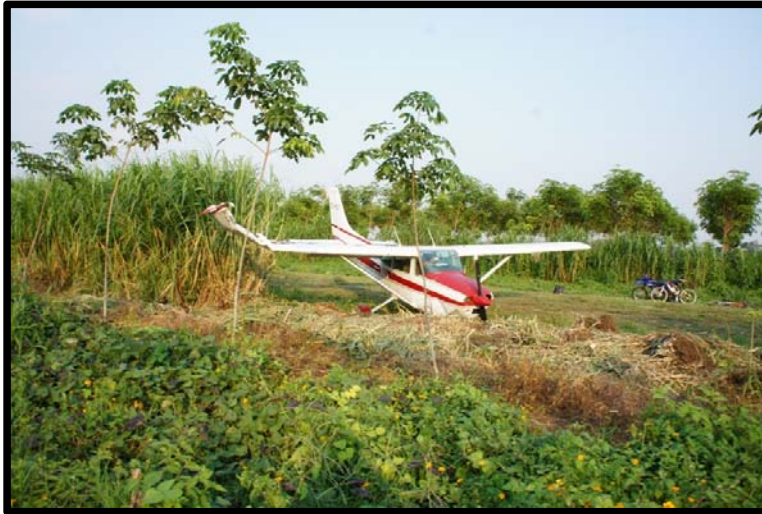
Fotografía No. 7 El daño en las alas y el Tren de nariz.
