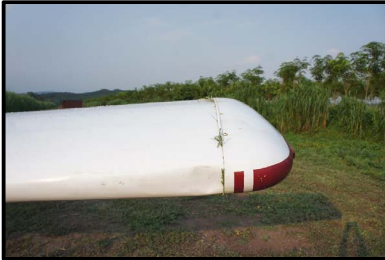
Fotografía No. 9 Golpe en el Borde de Ataque ala izquierda.
