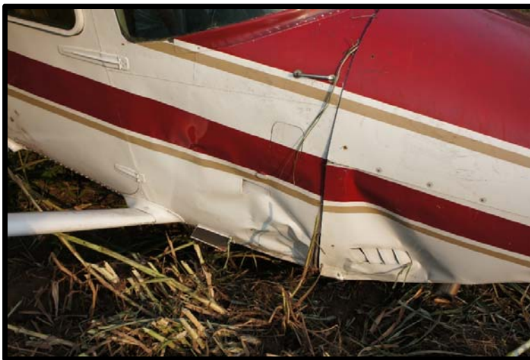
Fotografía No.6 Pared de Fuego y cobertores dañados.
